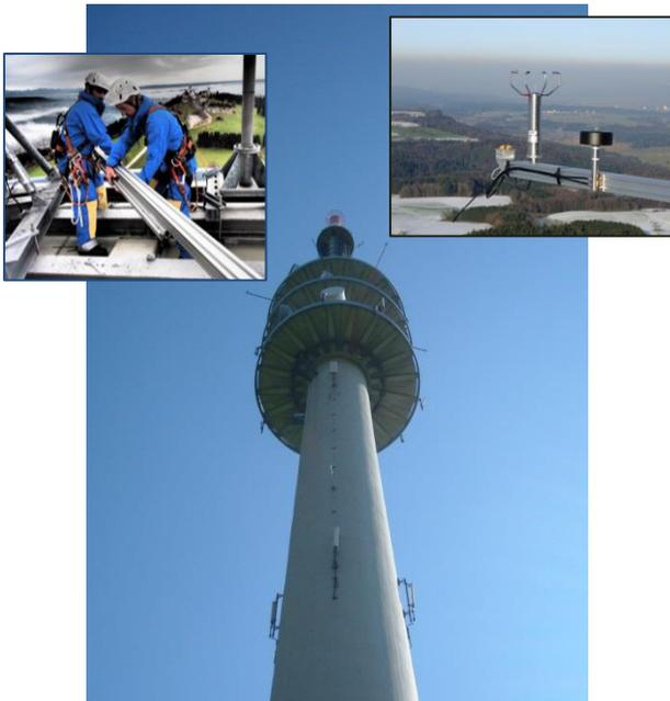
Im Atmosphären-Beobachtungsnetz werden kontinuierlich atmosphärische Treibhausgas- (THG) Konzentrationen ( $\text{CO}_2$ ,  $\text{CH}_4$  und  $\text{N}_2\text{O}$ ) erfasst, in Kombination mit den Radiokohlenstoff- und Tracer-Gehalten ( $\text{CO}$  and  $^{222}\text{Rn}$ ) von Luftproben. Dies geschieht mittels eines Deutschland-weiten Netzwerks aus 10 hohen Türmen und 2 Bergstationen.
