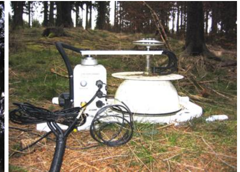
Automatische Hauben (Bodenatmung)
